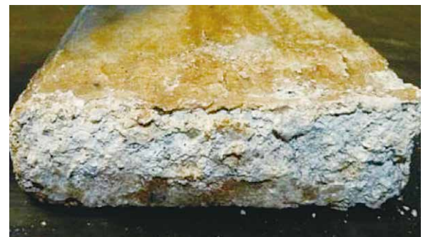
比較用試験体 (防食層未塗布)
